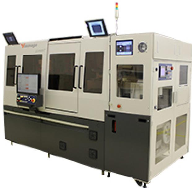
車載 I C 用外観検査装置
