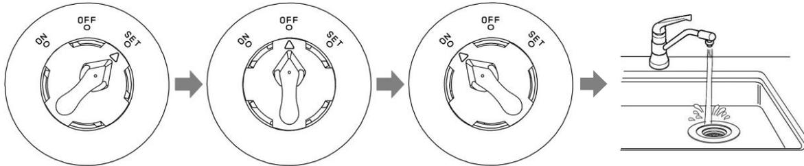
(この位置でフタスイッチを挿入します) (1段下に下がります。) (水が自動で流れた後、粉碎がはじまります。)
