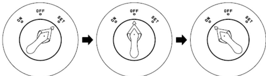
(この位置でフタスイッチを挿入します) (1段下に下がります。) (水が自動で流れた後、粉碎がはじまります。)
